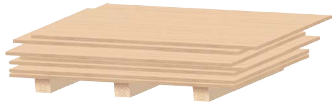
Fig. 4 - De platen zijn niet juist gestapeld. Hierdoor kunnen ze verkleuren en vervuild raken. Ook kunnen de randen makkelijk beschadigd worden.
